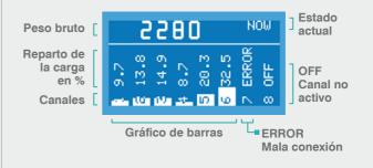
El TLM8 muestra gráficamente la señal de respuesta de las células de carga en mV en cada canal activo.
