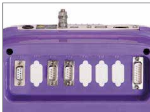
4 conectores D-SUB - IP40
