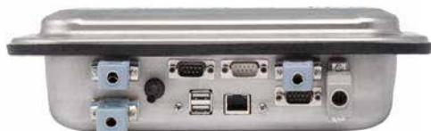
6 conectores D-SUB - IP40
