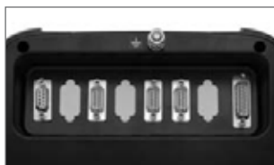
6 conectores D-SUB - IP40
