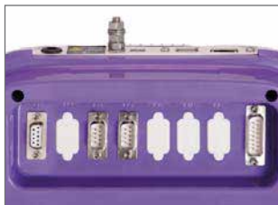
4 conectores D-SUB - IP40
