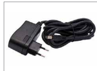
Alimentador estabilizado incluido 24 VDC/1 A - entrada 100÷240 VAC longitud cable de 3 m
